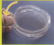
用手指逆時針旋轉上蓋可解除鎖定
